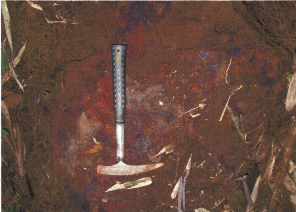
Foto 1. Bongkahan mangan yang telah mengalami limonitisasi (coklat kemerahan) terdapat Bukit Torsarahan, Taming Tengah, Silaping
