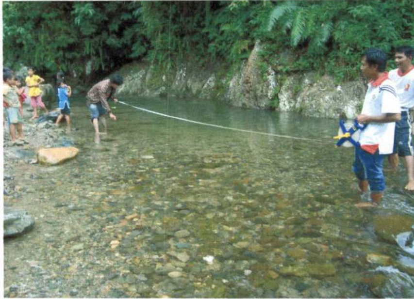
Gambar 7. Pengukuran Aliran Air Sungai Batang Marigi
